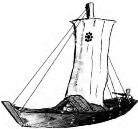
北上川のひらた船復元図 (約 18×4.5 m)
